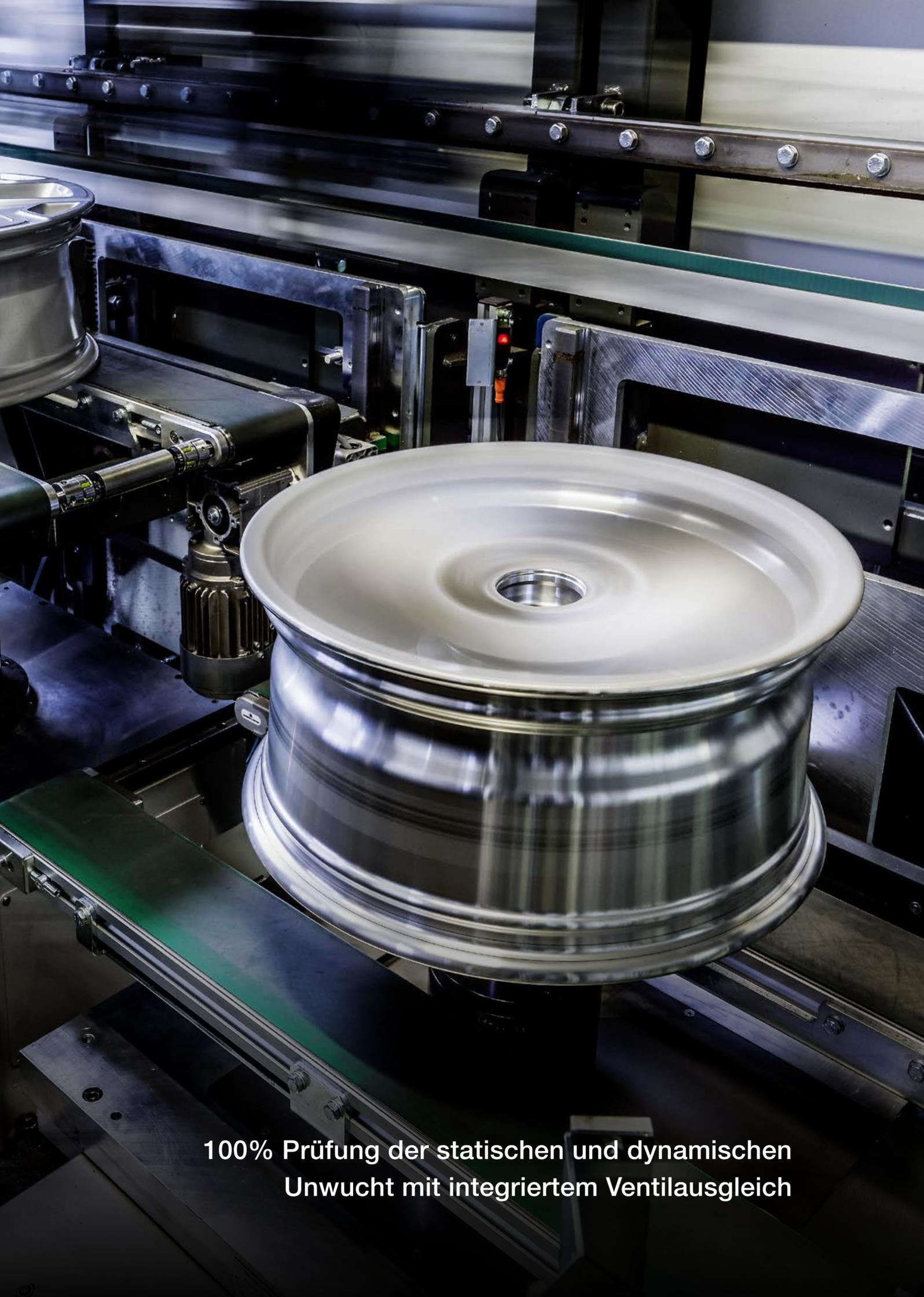
**100% Prüfung der statischen und dynamischen
