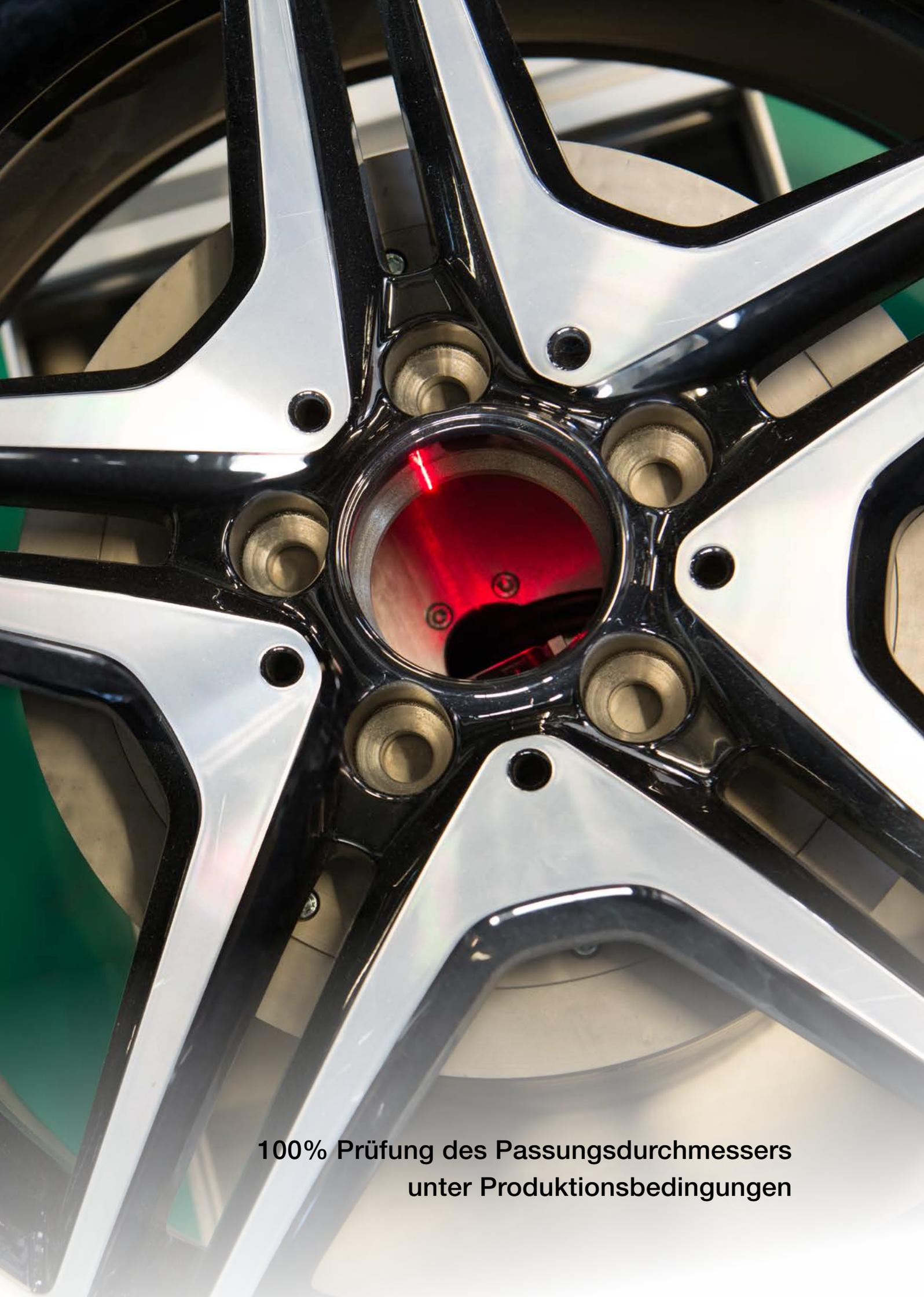
**100% Prüfung des Passungsdurchmessers
