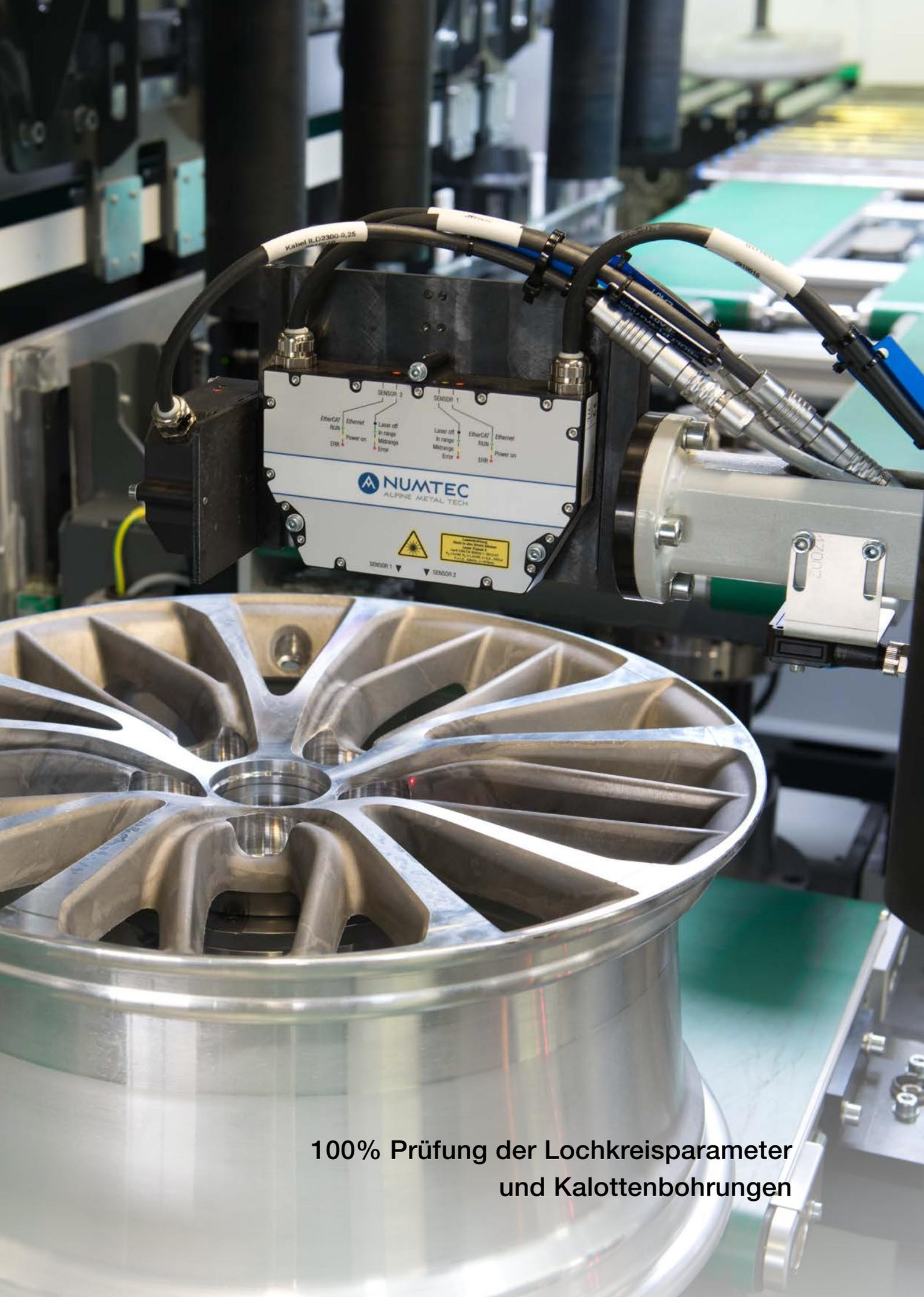
**100% Prüfung der Lochkreisparameter
