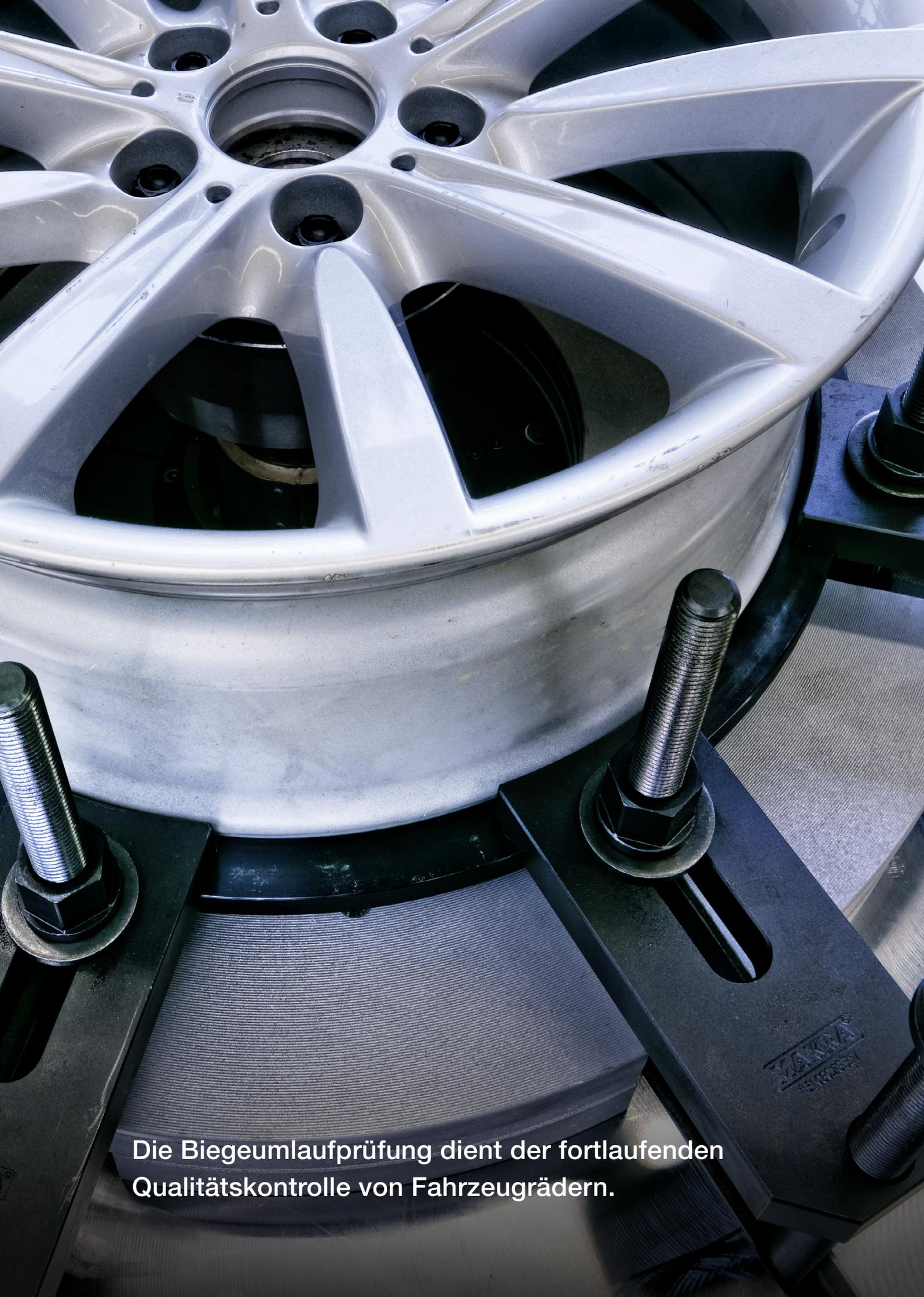
Die Biegeumlaufprüfung dient der fortlaufenden Qualitätskontrolle von Fahrzeugrädern.
