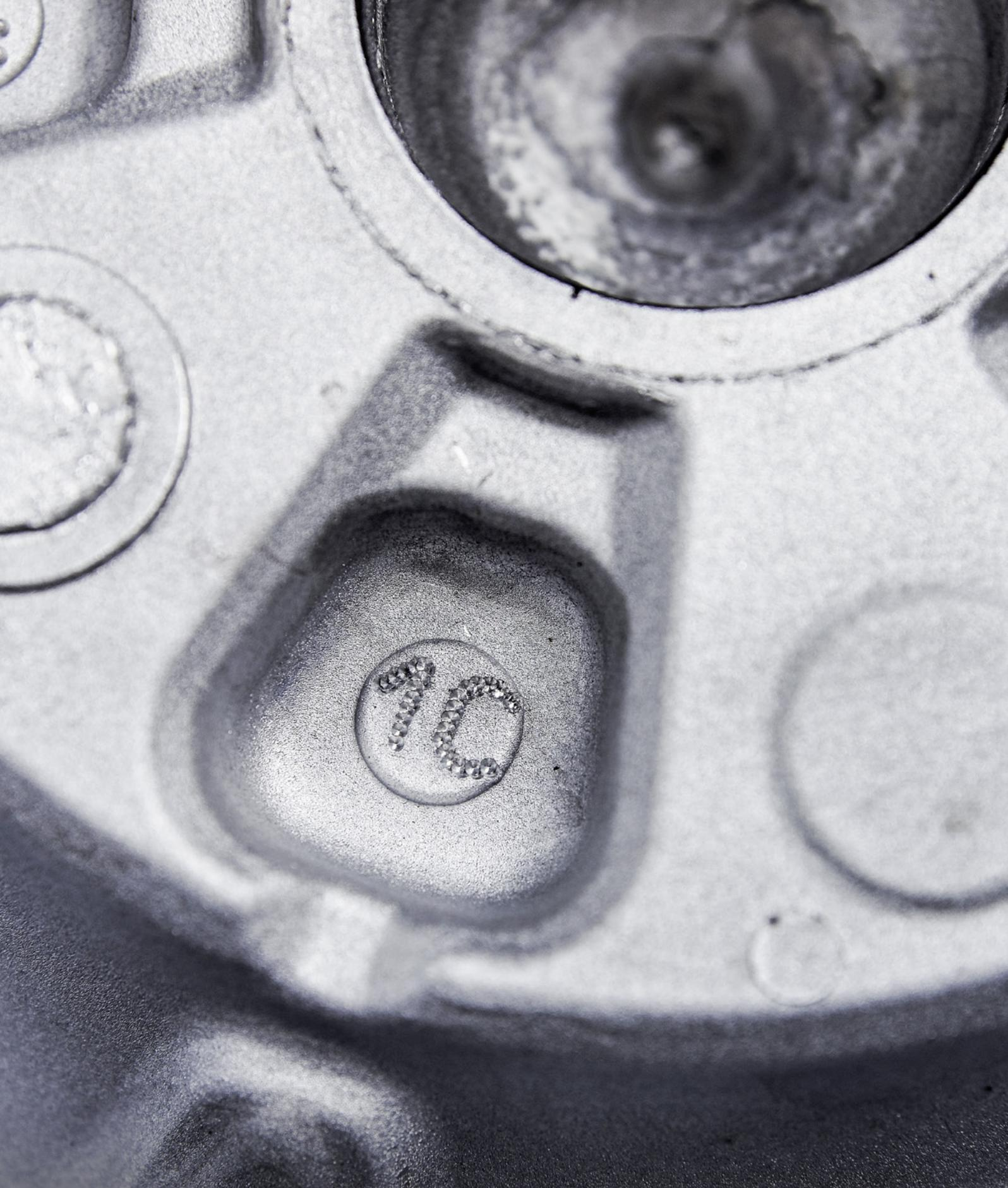
Die MARK100 Markieranlage ist ein Komplettsystem zum automatischen Einprägen von Schriftzeichen in die Innenseite von Aluminiumrad-Rohlingen.
