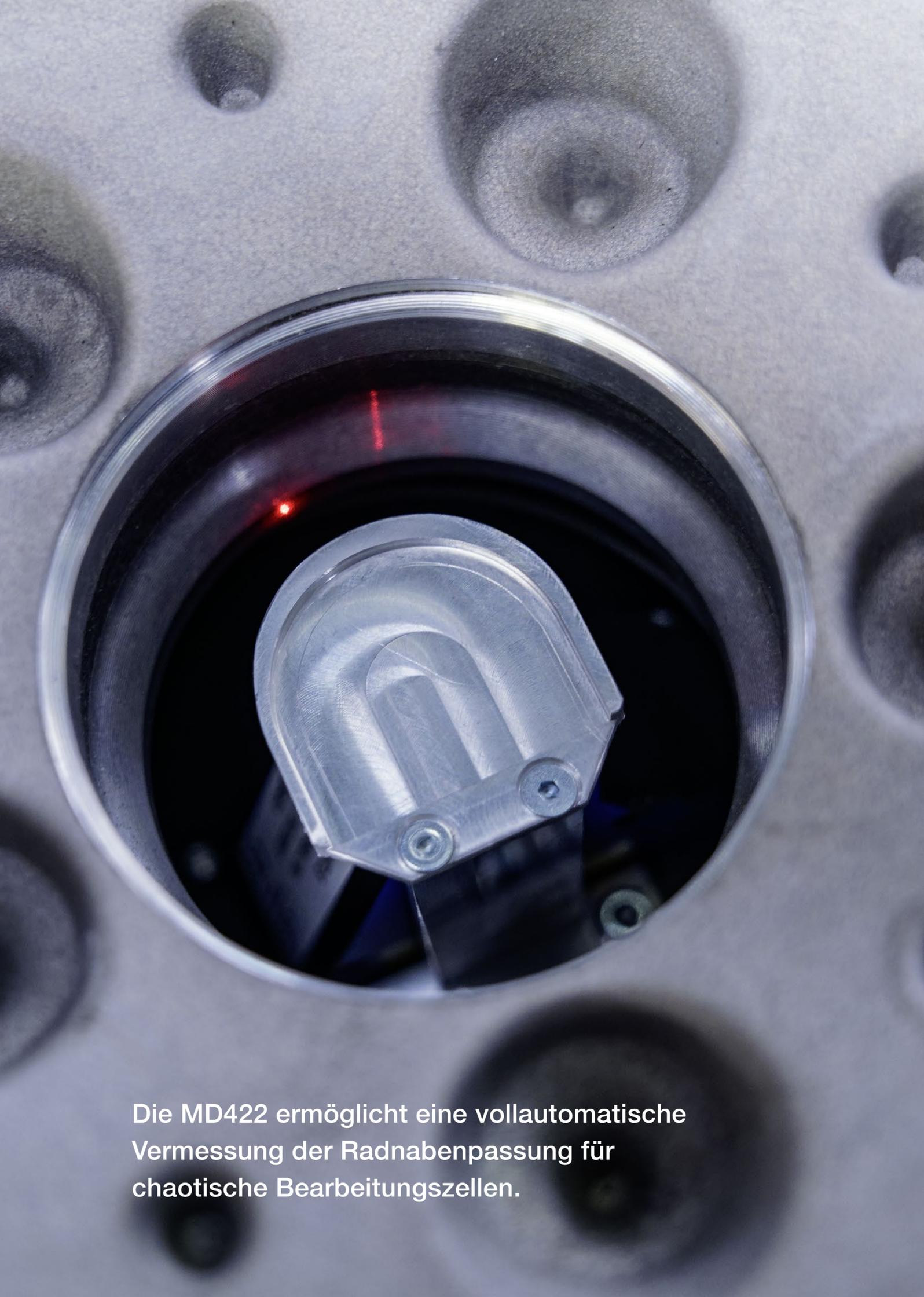
Die MD422 ermöglicht eine vollautomatische Vermessung der Radnabenpassung für chaotische Bearbeitungszellen.
