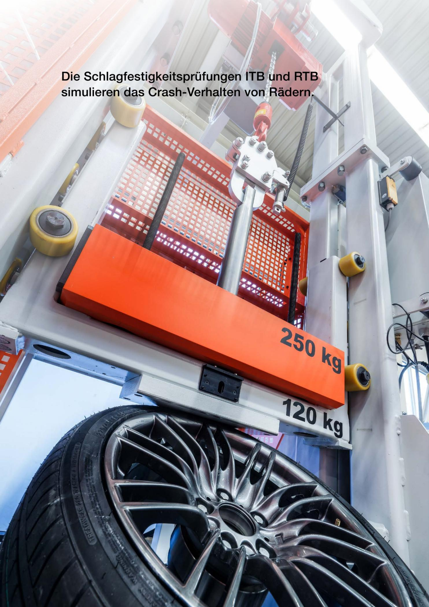
Die Schlagfestigkeitsprüfungen ITB und RTB simulieren das Crash-Verhalten von Rädern.
