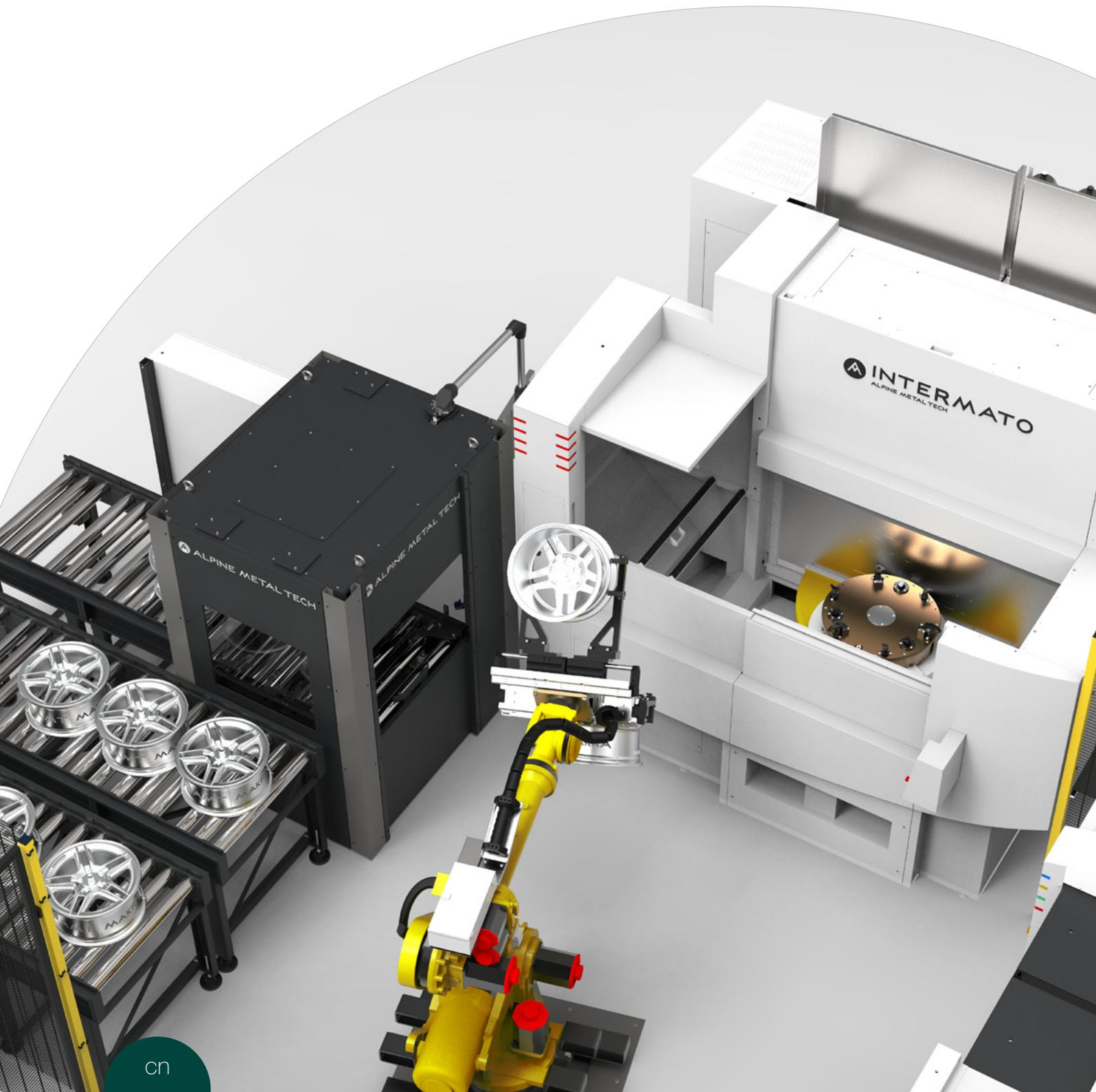
Alpine Metal Tech机器人单元自动化可实现混线生产，可以同时加工不同类型的车轮，无需进行新设置。
