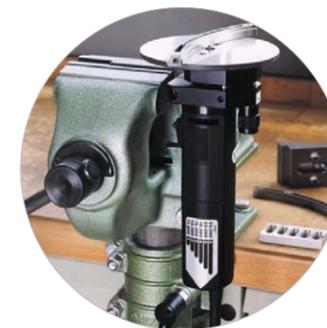
KEG 251 T – durch anschraubbarem Einspannschaft umbaubar zu stationärem Einsatz
