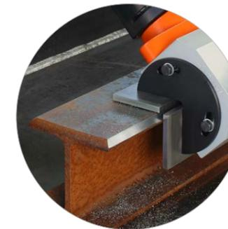
KEG 152 V – Schweißfasen und Bearbeitung gerader Kanten bei großen Werkstücken
