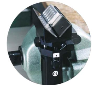
Stationärer Einsatz am Werkbank-Schraubstock für rechtwinklige Werkstücke
