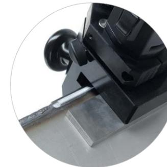
Schweißnahtüberstand bei der Bearbeitung von dünnen Blechen
