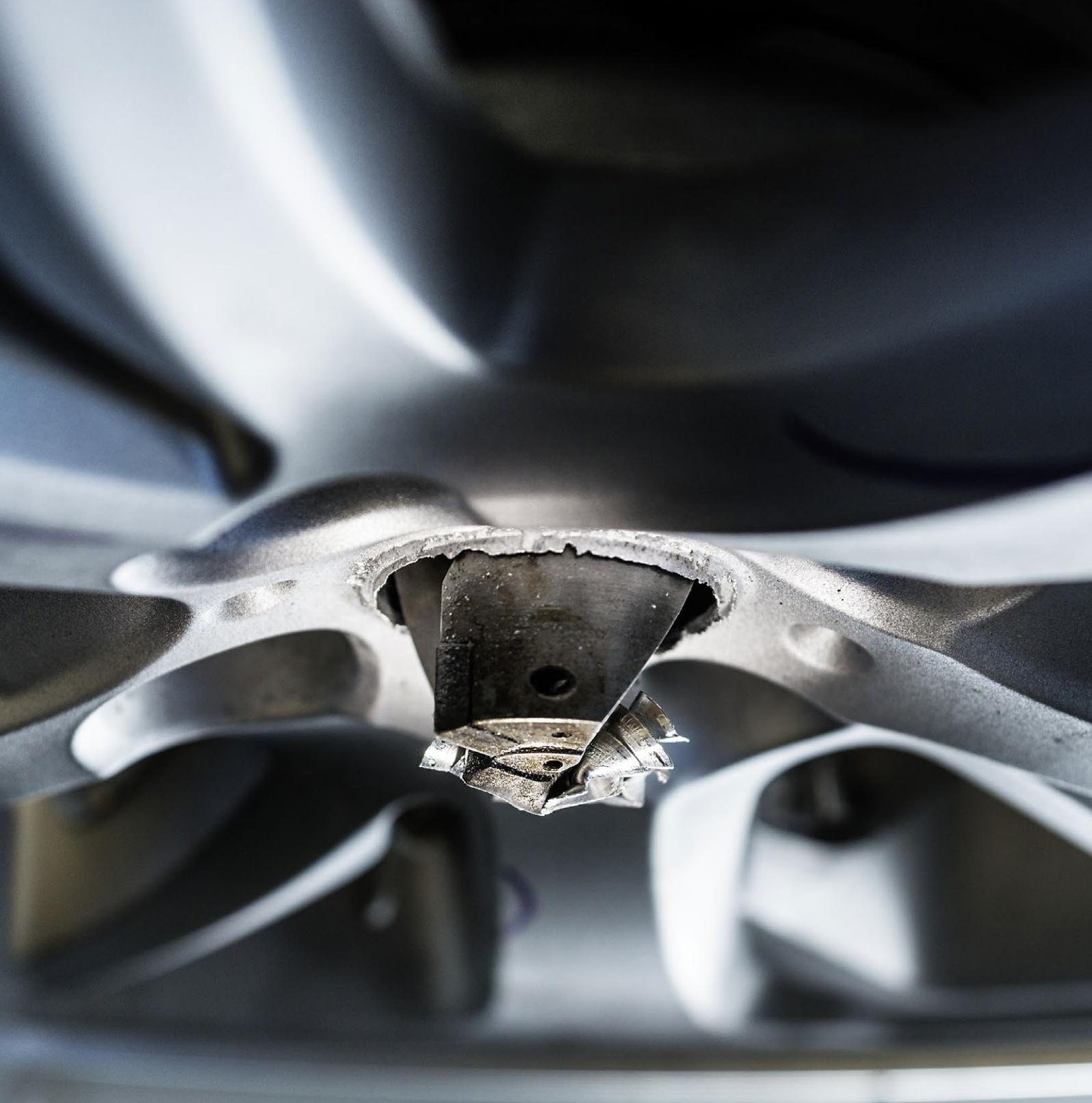
**ABV300 – eine leistungsstarke Hightech-Bohrmaschine mit automatischem Werkzeugwechsler zum Ausbohren von Angusszapfen an Aluminiumrädern**
